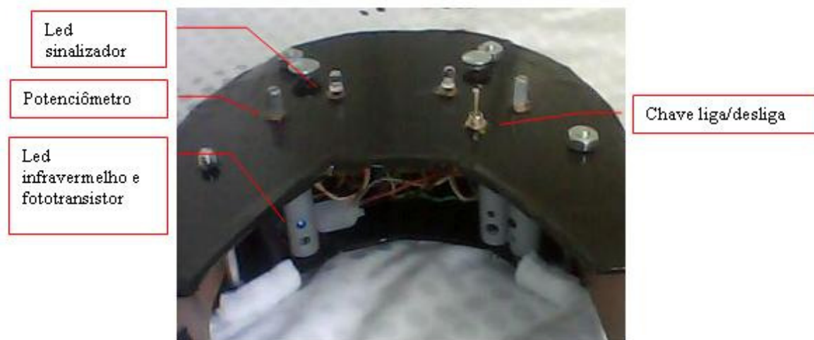
Figura 3 – Vista frontal superior do equipamento de aquisição de estímulos da face (Fonte: Nery, 2011, p.7)
